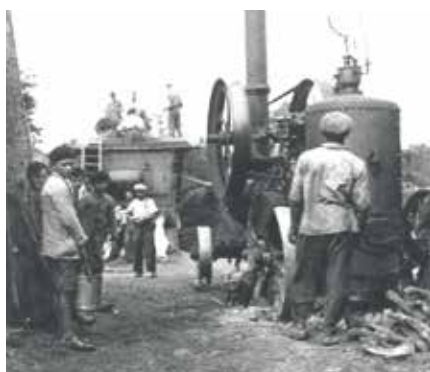
La locomobile à vapeur, pour le temps des battages
